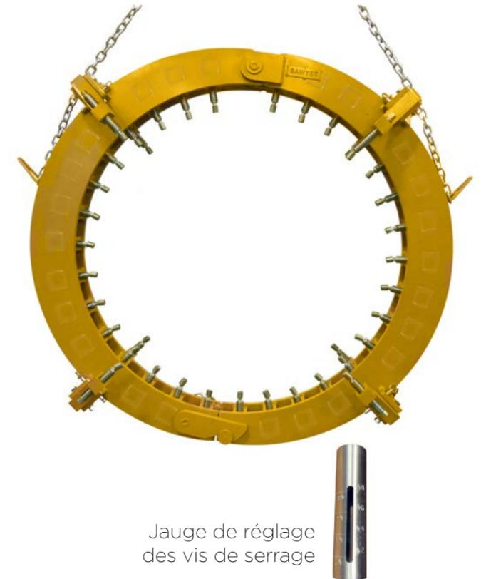
Jauge de réglage des vis de serrage
